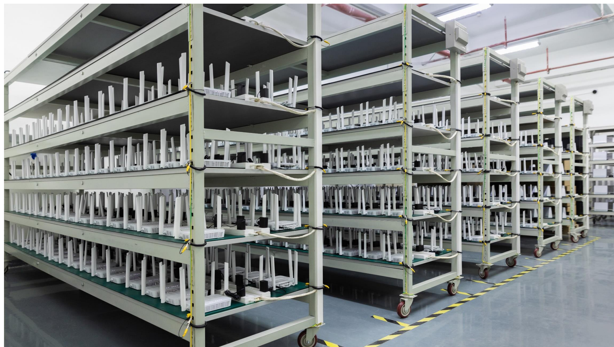
Испытание на старение
